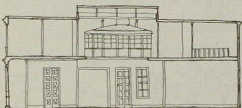
Planta y corte de una típica vivienda en Iquique, hoy convertida en el Museo de la Universidad del Norte. Espacio central abierto con lucarna.
