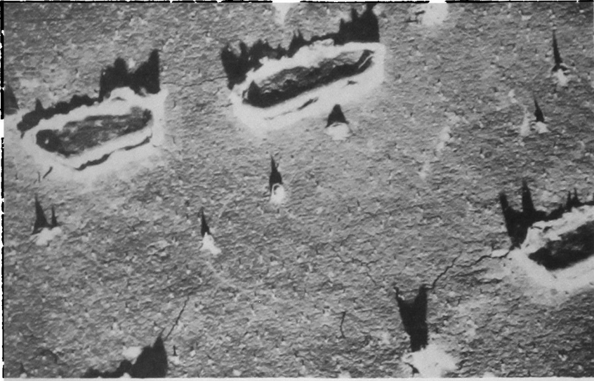
Fig. 1. Ataque térmico en aire y ataque químico con reactivo de Perryman por 30 seg. Se observan microfiguras de ataque térmico en los lugares donde el reactivo ha disuelto la capa de óxido. Réplica a 10.500 X.
