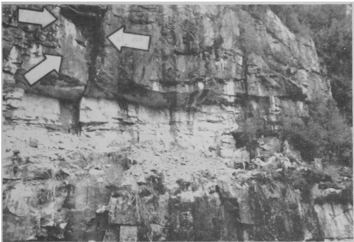
Fig. 5. Triedro originado por la caída de un bloque rocoso en forma de cuña. Farellón Piedra del Gato. Puerto Cisnes. XI Región 8 .
